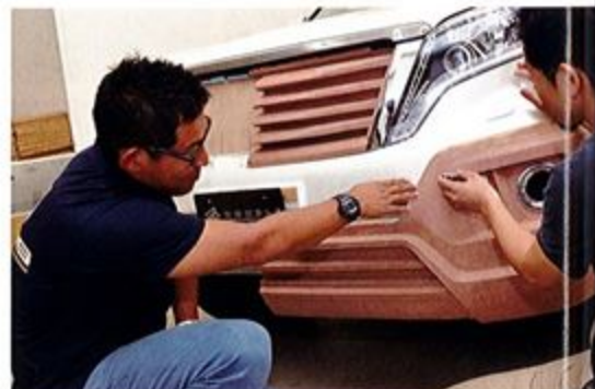
フィンの間隔を大きく取ることで、より大きく迫力あるフロントマスクを作るオリジナルのフロントグリル。
