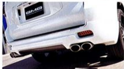
リアもDOUBLE EIGHTリアハーフスボイラーを装着。マフラーはスボイラーにマッチした同じくDOUBLE EIGHTのオーバル4本出しマフラーを組み合わせる。
