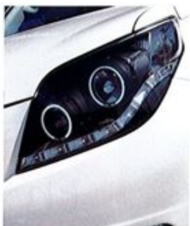
個性的なフロントマスクを作るCCFLイカリリング/LED付きヘッドライト。レンズはスモーク塗装に。
