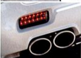
LEDテールランプに、LEDバックアップランプ。ともにスモークレンズ仕様で、ボディカラーに合わせて塗り分けられている。
